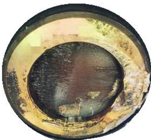
Рис. 6. Поверхности излома оси №1
