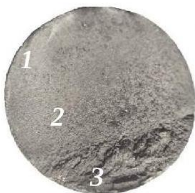
Рис. 8. Усталостное разрушение с характерными зонами
