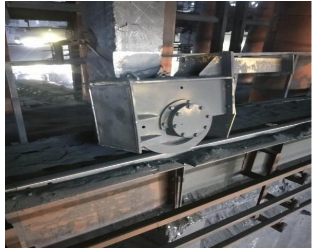
Рис. 3. Полное разрушение сварных соединений по границе металла сплавления стенок модуля холостого колеса с вертикальным листом концевой балки со стороны троллей
