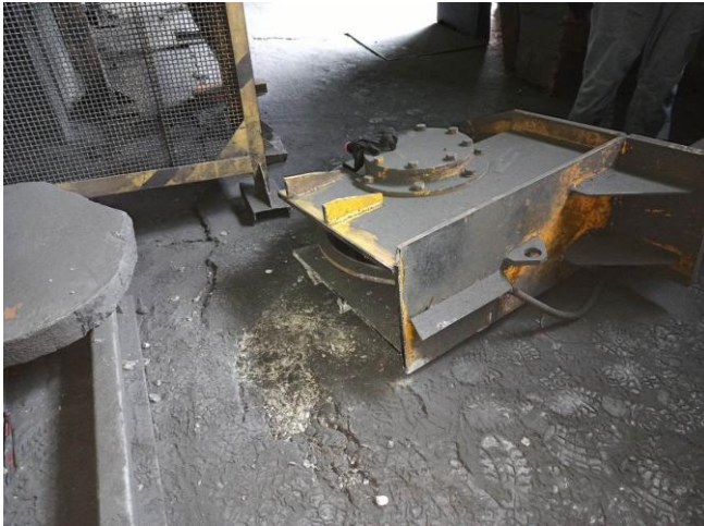
Рис. 2. Полное разрушение сварных соединений по границе металла сплавления стенок модуля холостого колеса с вертикальным листом концевой балки со стороны кабины крановщика
