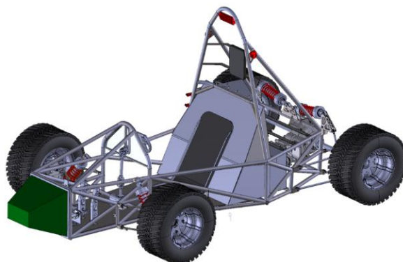
Рис. 2. Конструкция гоночного автомобиля, спроектированного по регламенту FSAE, с энергопоглощающим элементом (на рис. обозначен зеленым цветом)
