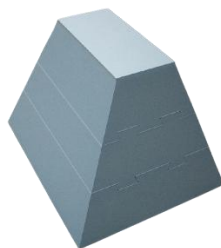
Рис. 21. Модель энергопоглощающего элемента с пазовой системой крепления, зафиксированной клеевой основой Imрах
