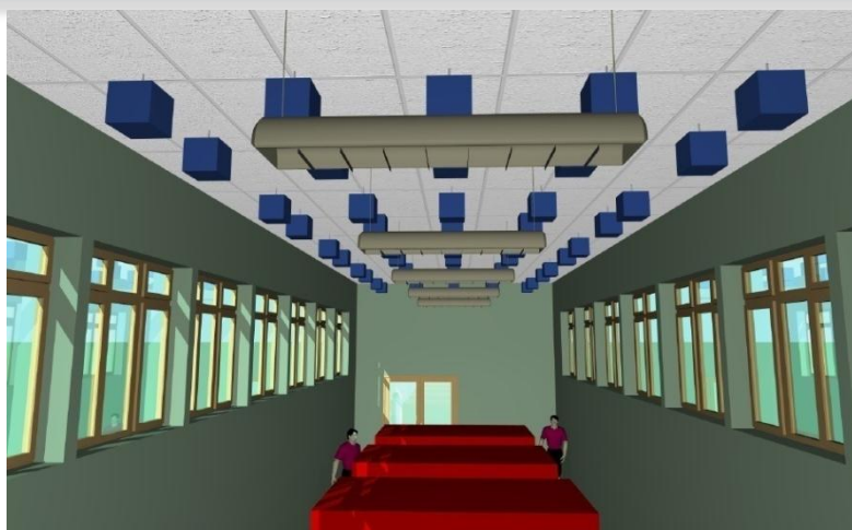
Рис. 5. Модель размещения объемных звукопоглотителей
