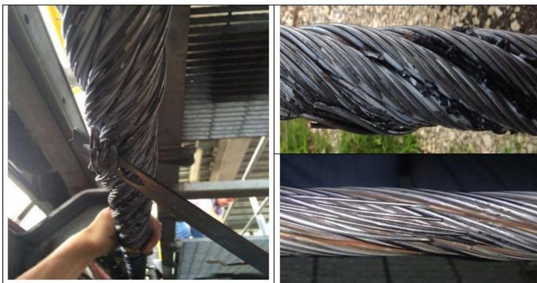
Рис. 6. Фотография дефекта на одной из прядей в месте счалки в виде обрывов проволок каната конструкции 6 \times 26(1+5+5/5+10) WS-SPC 1600 B zZ
