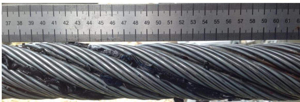
Рис. 2. Фотография дефектного участка каната с волнистостью диаметром 48 мм, конструкции 6×26(1+5+5/5+10) WS-SPC 1600 В zZ
