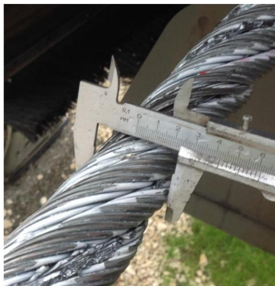
Рис. 3. Фотография замеров диаметр каната конструкции 6 \times 26(1+5+5/5+10) WS-SPC 1600 B zZ на участке между узлами счалки
