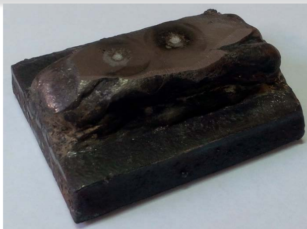
Рис. 3. Образец для химического анализа наплавленного металла проволокой Innershield NR-207.
