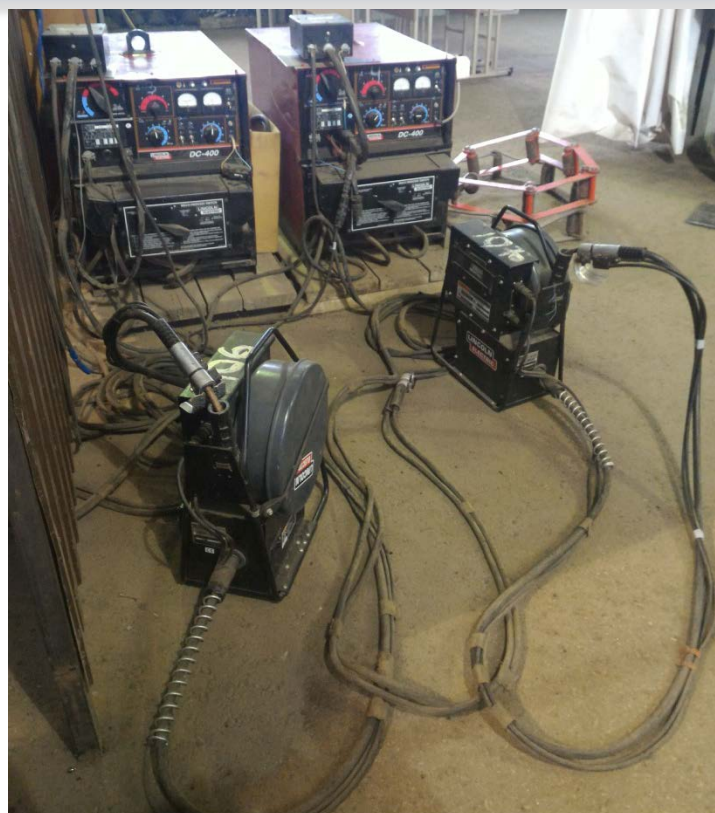
Рис. 2. Сварочное оборудование Lincoln Elektrik, используемое для наплавки проволокой Innershield NR-207.
