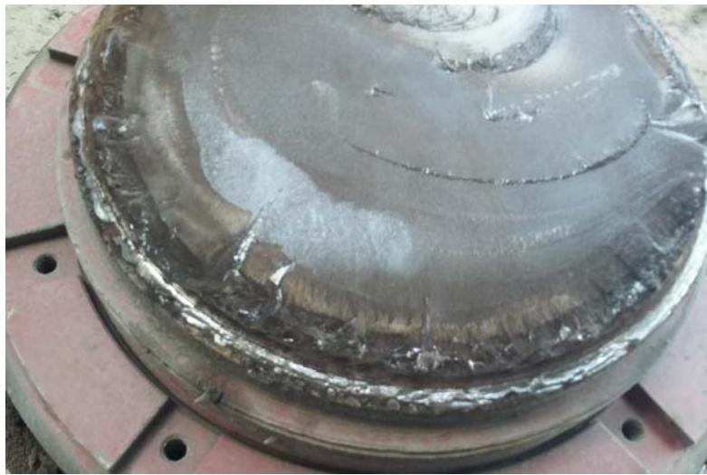
Рис. 4. Поверхность разрушения сечения эксцентрикового вала со следами сварки по периметру
