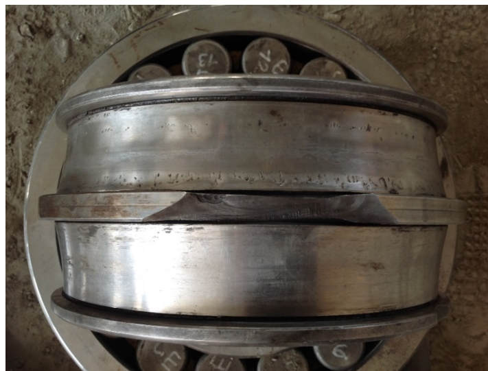
Рис. 9. Дефект в виде раскалывания боковой поверхности ребра внутренней обоймы
