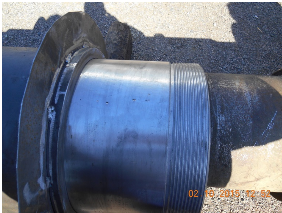
Рис. 7. Поверхностные поры от электродуговой сварки на поверхности обработанной шейки вала
