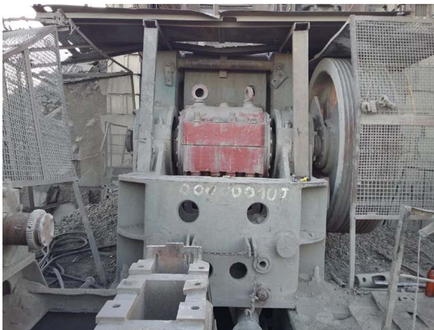
Рис. 1. Общий вид щековой дробилки СМД-111 после аварии
