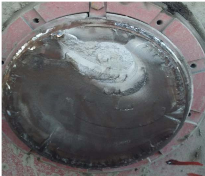
Рис. 5. Поверхность разрушения сечения эксцентрикового вала с зоной усталостного разрушения и долома
