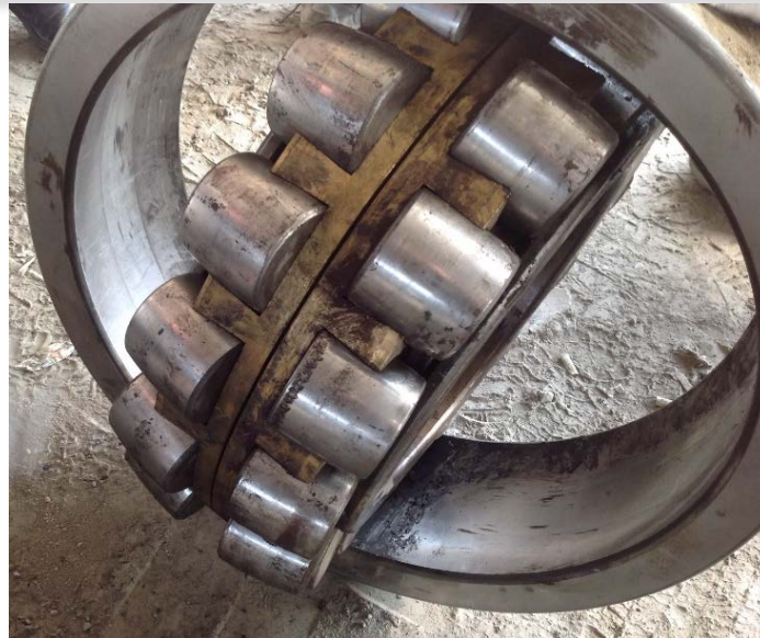
Рис. 8. Дефекты в виде выкрашивания поверхности качения внутренних обойм и роликов
