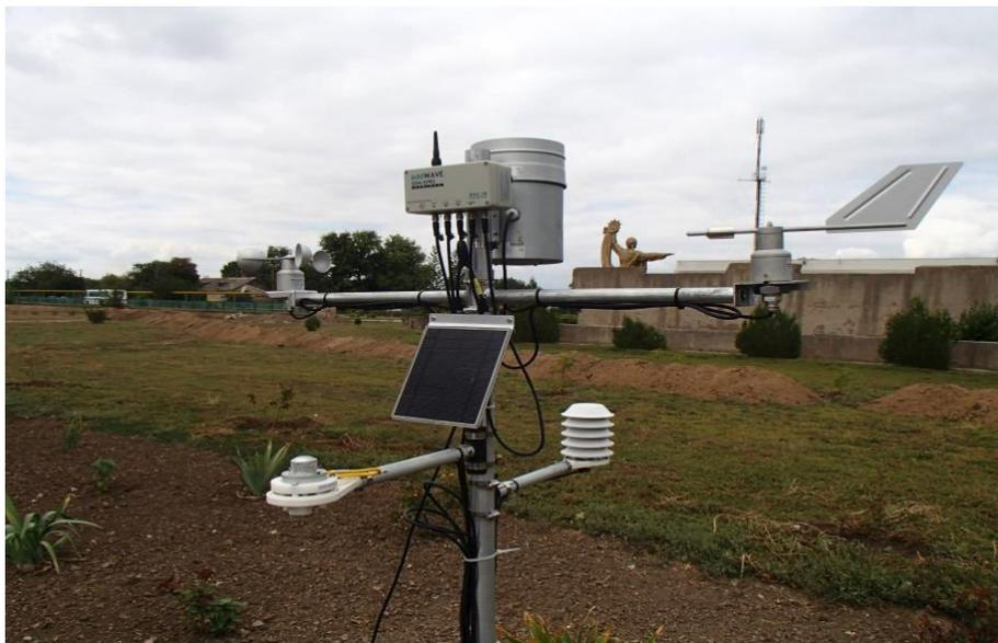
Рис. 3. Система мониторинга погодных условий [3]
