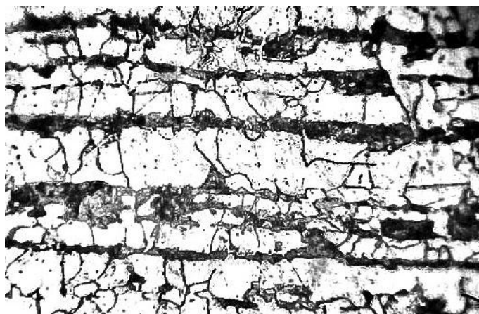
Рис. 2. Сталь 14Г2 со структурой ЕФМК после закалки от 780 °С (29 % мартенсита), \times 360
