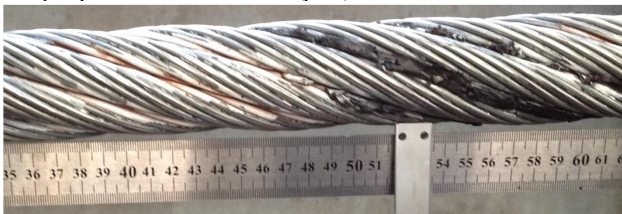
Рис. 1. Образование опасного фактора «волнистость» на участке счалки стального каната
