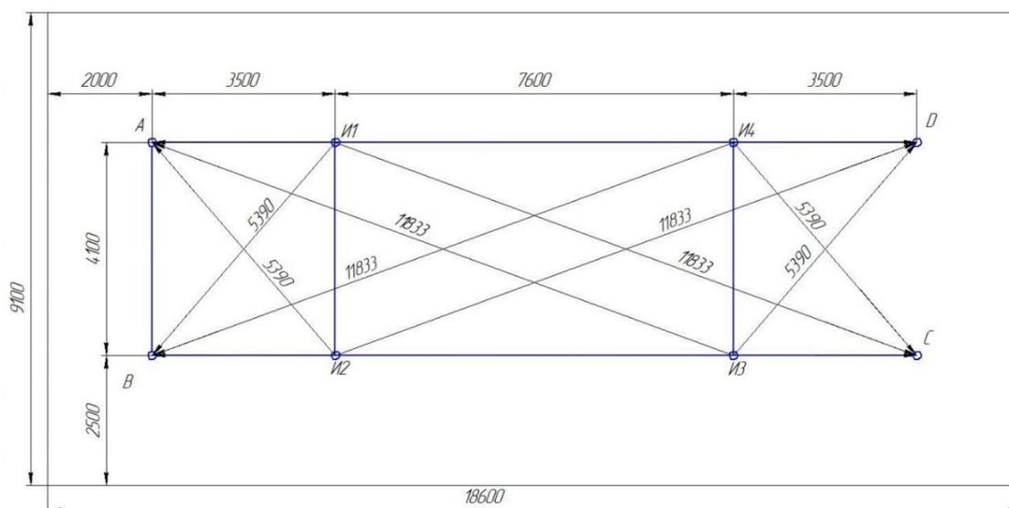
Рис. 3. Схема для расчета эпюры облучения работников при перемещении оборудования в литейном цехе
