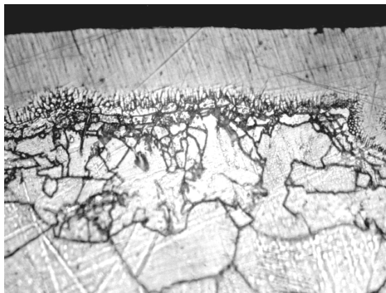
Рис. 2. Микроструктура зоны контакта хромового покрытия с латунью после лазерного облучения
