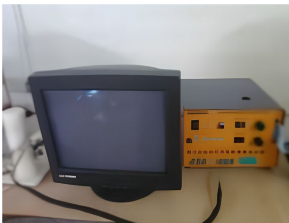
Рис. 2. Прибор для определения коэффициента теплопроводности
