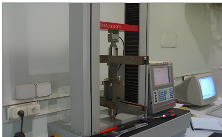
Рис. 4. Устройство для испытания на прочность при сжатии
