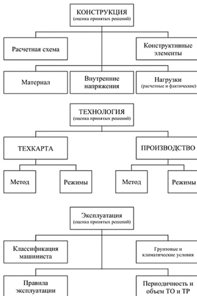
Рис. 3. Структура комплексного анализа входных факторов детали
