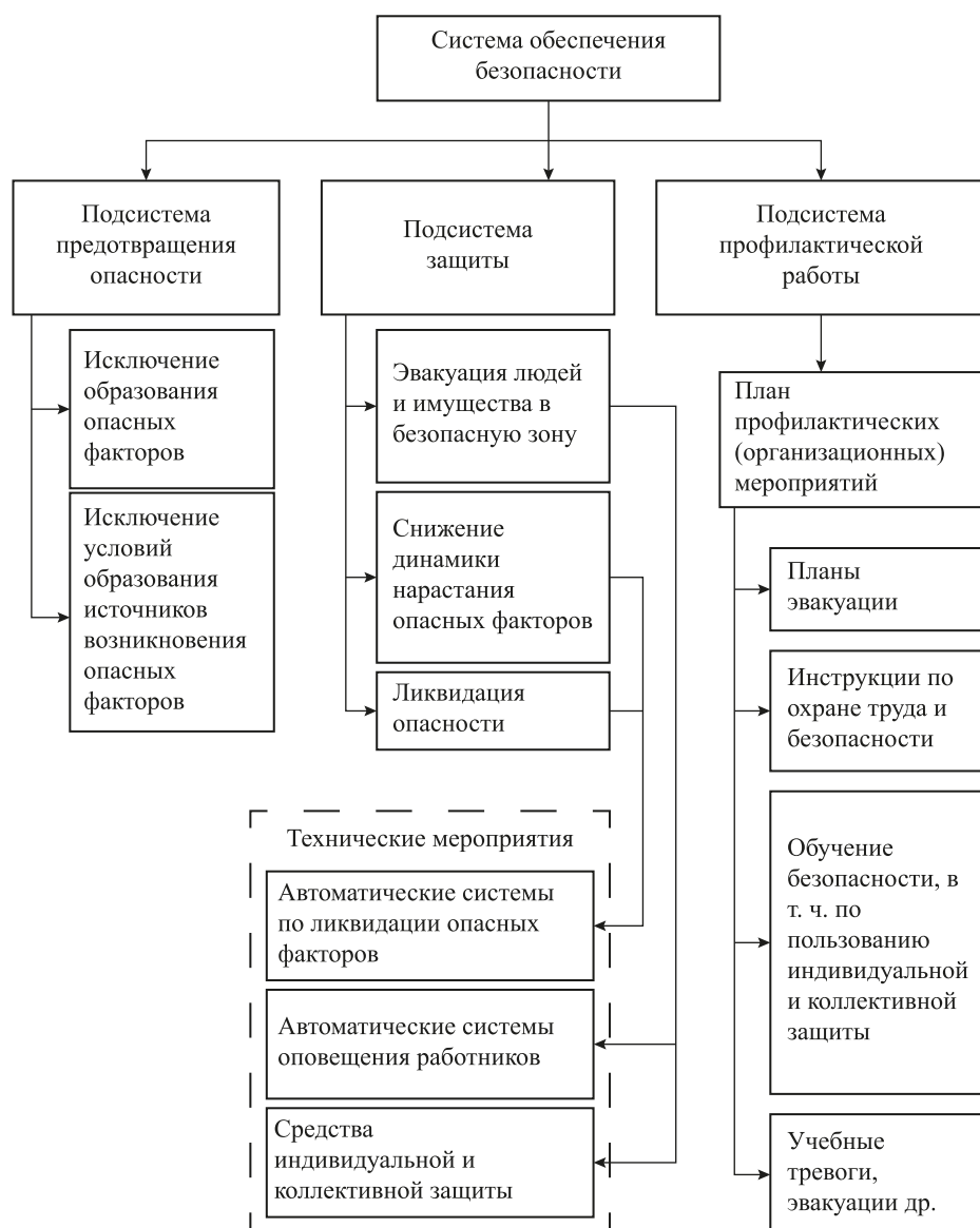
Рис. 1. Система обеспечения пожарной безопасности объектов
