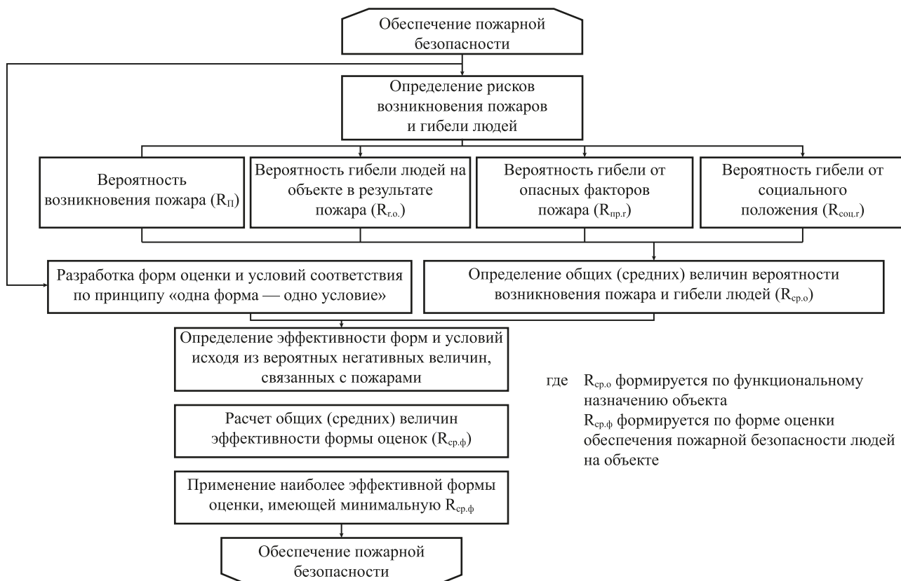
Рис. 8. Проект методологического принципа оценки и обеспечения пожаробезопасности людей
