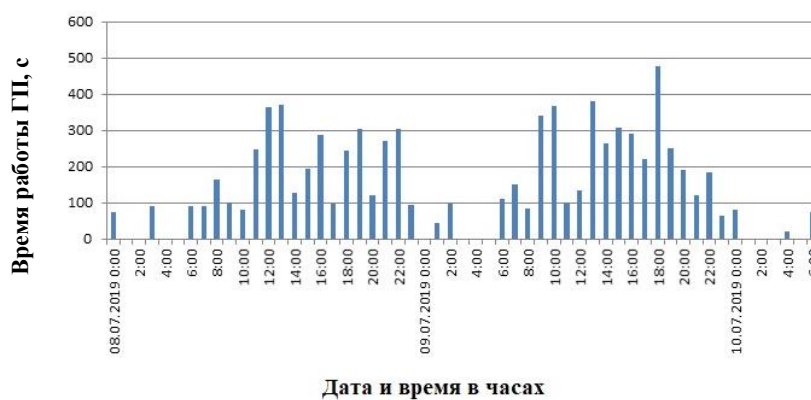
Рис. 4. Чистое время работы ГП в течение часа (ул. Орбитальная, 68, подъезд 1)
