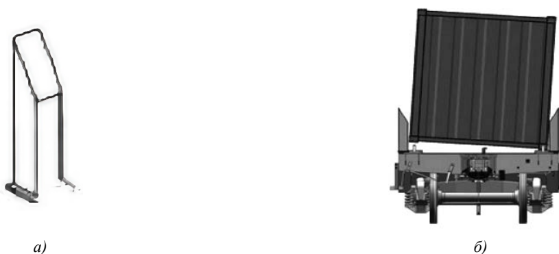
Рис. 11. Запирающее устройство [13]: а — схематическое изображение; б — место на платформе
