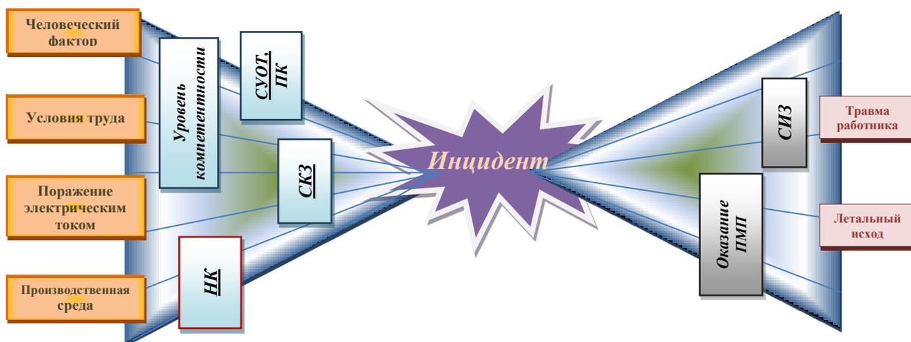
Рис. 1. Схема метода «галстук-бабочка» для иницирующего события «инцидент» с барьером «неразрушающий контроль»: СУОТ — система управления охраной труда; ПК — производственный контроль; НК — неразрушающий контроль; СКЗ, СИЗ — средства коллективной и индивидуальной защиты; ПМП — первая медицинская помощь
