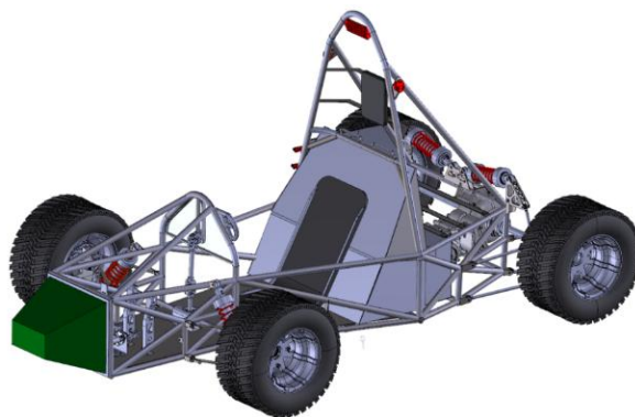
Рис. 2. Конструкция гоночного автомобиля, спроектированного по регламенту FSAE, с энергопоглощающим элементом (на рис. обозначен зеленым цветом)
