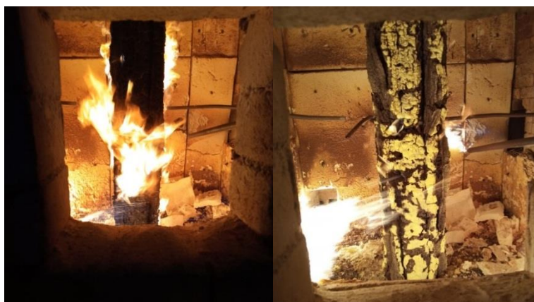
Рис. 1. Результат огневого испытания в стандартной печи двутавровой колонны с интумесцентным покрытием составом 1: а — через 10 мин после начала обжига; б — через 30 мин
