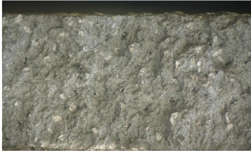
Рис. 1. Внешний вид излома плавков 5–8 (увеличение  $\times 6,5$ )
