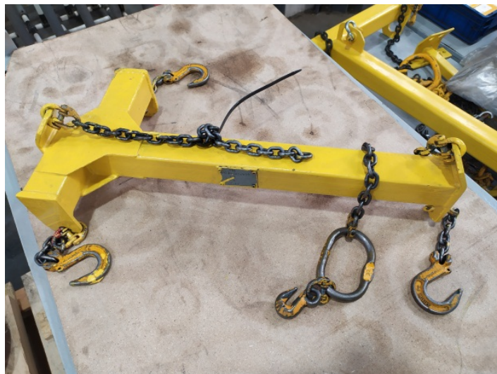
Рис. 9. Захват ПК ПМ-001501 без замков на крюках
