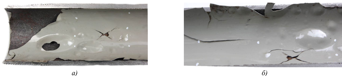
Рис. 2. Разрушение внутреннего антикоррозионного полимерного покрытия: а — вздутия покрытия; б — растрескивания покрытия
