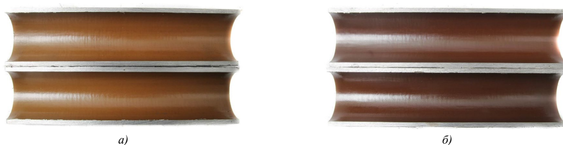
Рис. 3. Разнооттеночность внутреннего антикоррозионного покрытия НКТ: а — светло-коричневый оттенок покрытия; б — темно-коричневый оттенок покрытия
