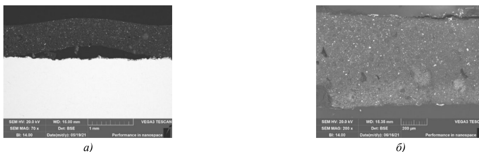
Рис. 8 Микроструктурные исследования антикоррозионного покрытия в области разрушения: а — отслоение покрытия; б — деструкция полимерного покрытия
