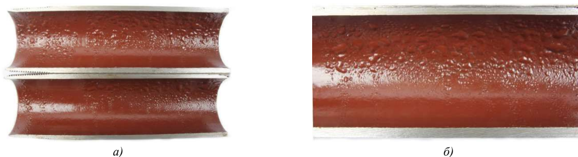
Рис. 1. Повреждения внутреннего антикоррозионного покрытия: а, б — вздутия покрытия
