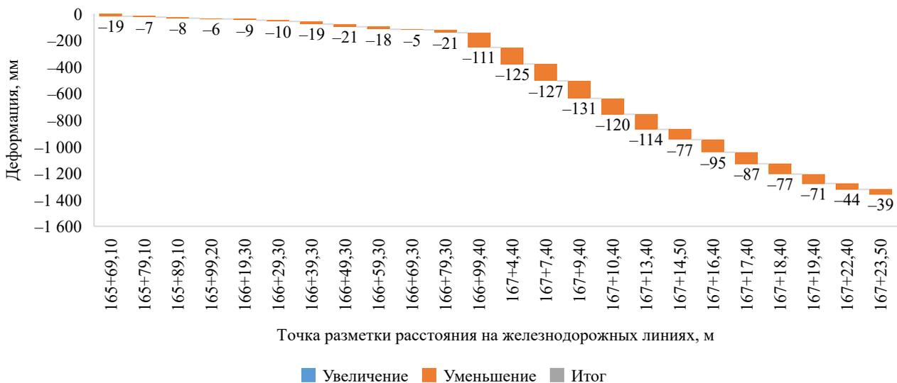
Рис. 17. График деформации обделки II пути 6 отм.
