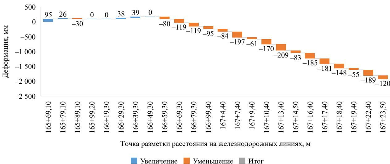
Рис. 16. График деформации обделки II пути 5 отм.
