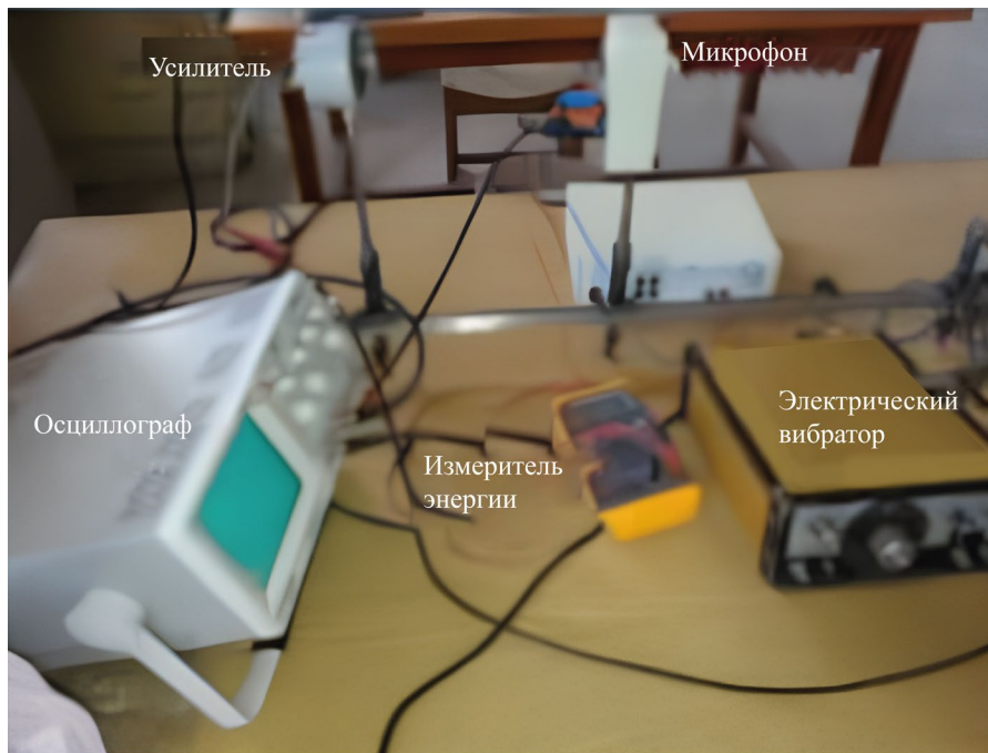
Рис. 6. Прибор для измерения коэффициента звукопоглощения
