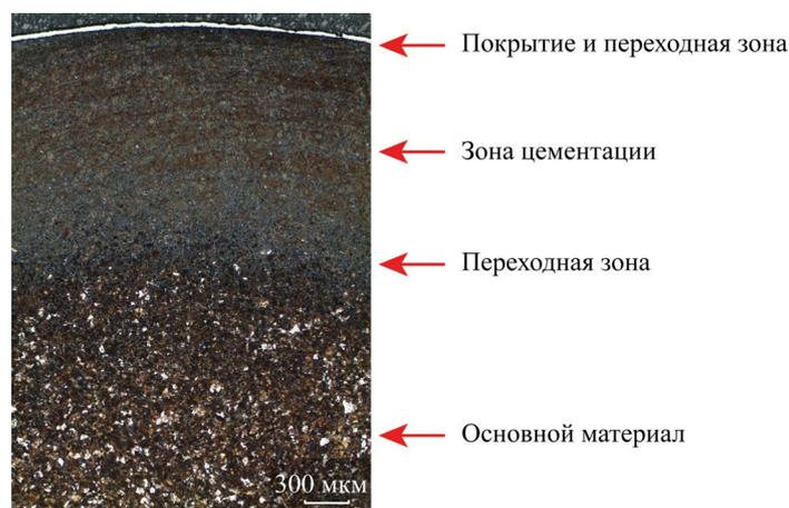
Рис. 2. Структура образца после КХТО
