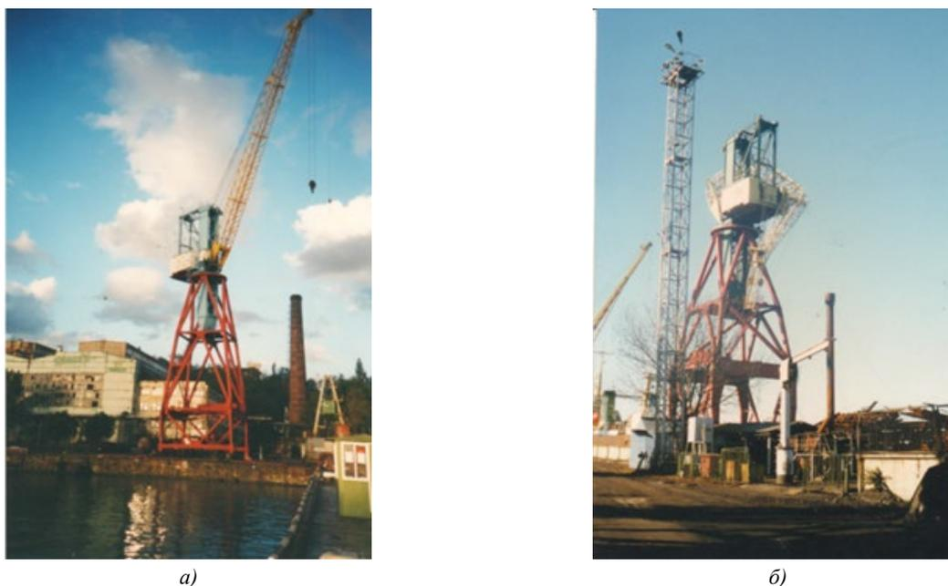
Рис. 3. Авария портального крана по причине разрушения механизма подъема:
