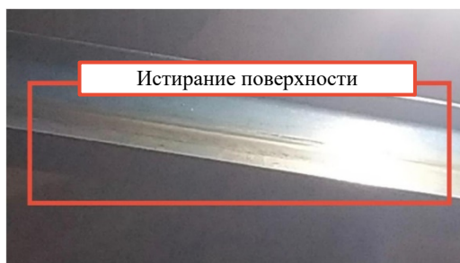
Рис. 8. Истирание боковой поверхности двутавровой балки
