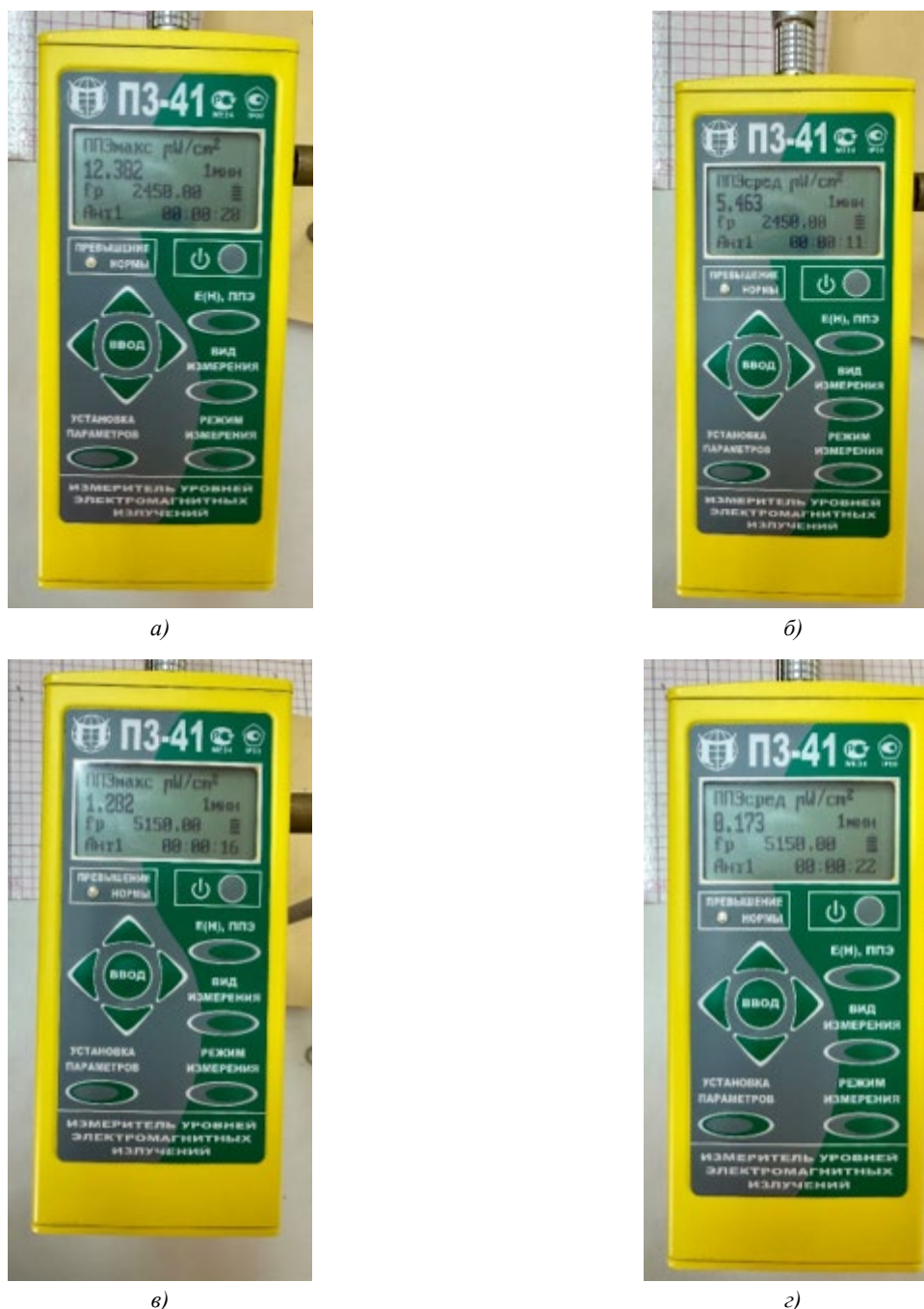
Рис. 1. Интерфейс прибора ПЗ-41 при измерении ППЭ макс и ППЭ средн на частотах 2450 МГц и 5150 МГц: а — определение ППЭ макс на частоте 2450 МГц, б — определение ППЭ средн на частоте 2450 МГц, в — определение ППЭ макс на частоте 5150 МГц, г — определение ППЭ средн на частоте 5150 МГц
