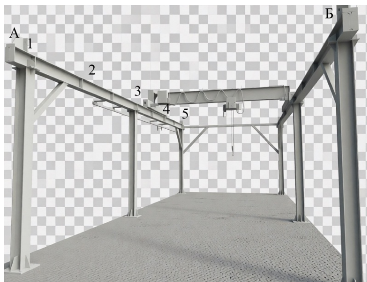
Рис. 4. Модель однобалочного мостового крана с крановыми путями
