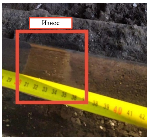
Рис. 9. Износ рельса в результате буксования колеса крана
