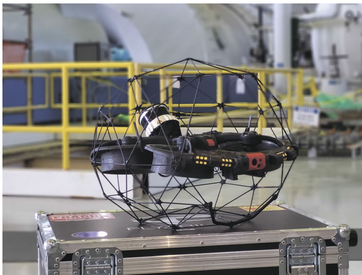
Рис. 1. Промышленный инспекционный FPV-дрон (квадрокоптер) с защитным каркасом
