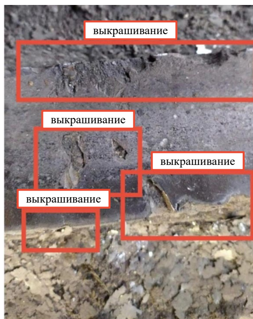
Рис. 7. Износ рельса с выкрашиванием и раковинами
